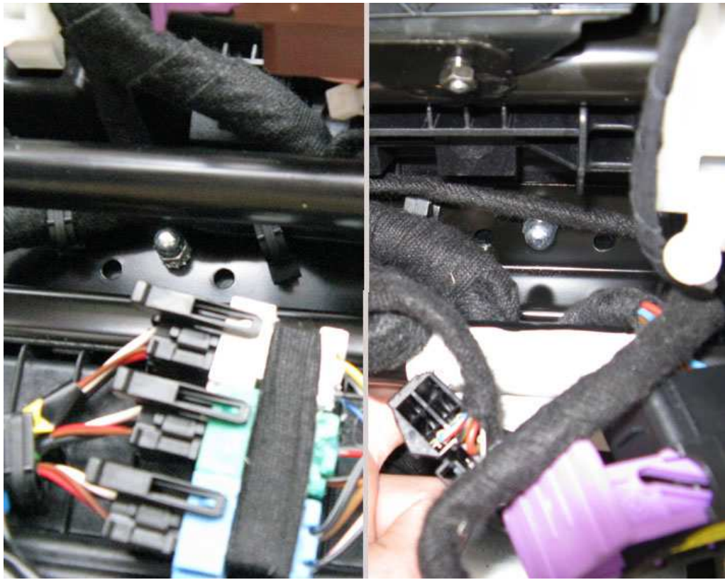
8. 将电气接头从底座上撬出。
