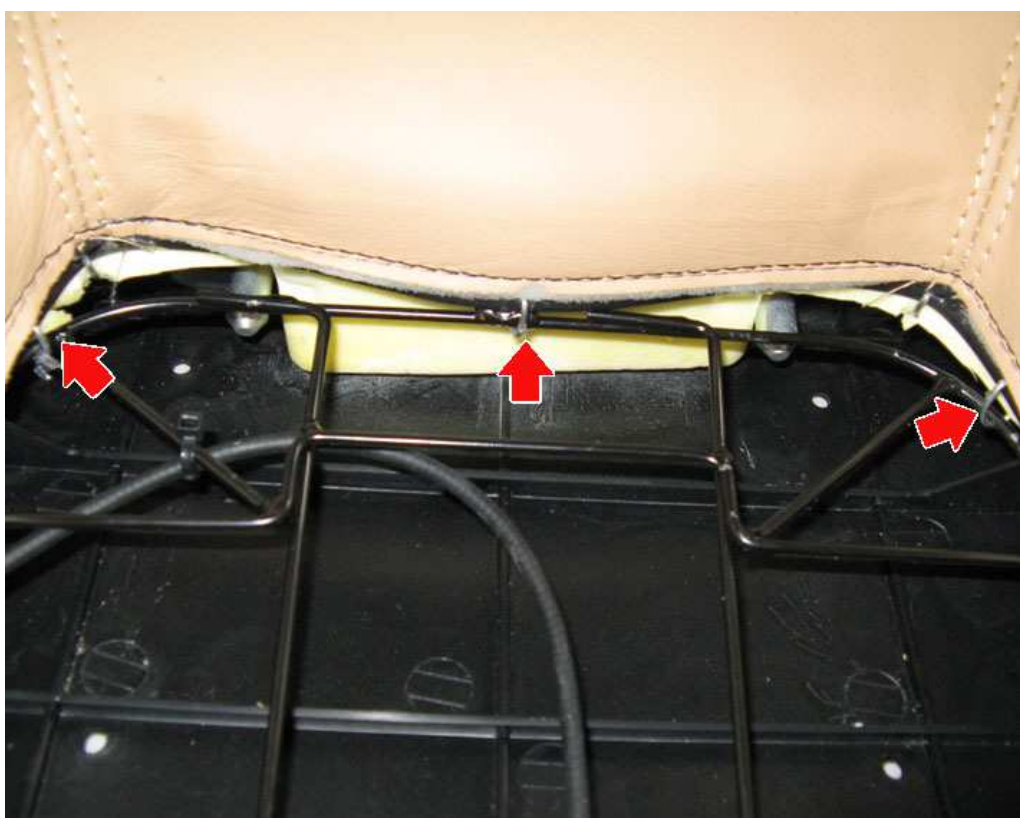
7. 拆卸右侧和左侧的座椅靠背倾斜装置（通过压力安装的）。
