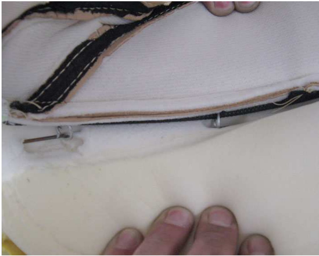
15. 从衬垫、衬料和加热器组件上拔出座垫加固装置。
