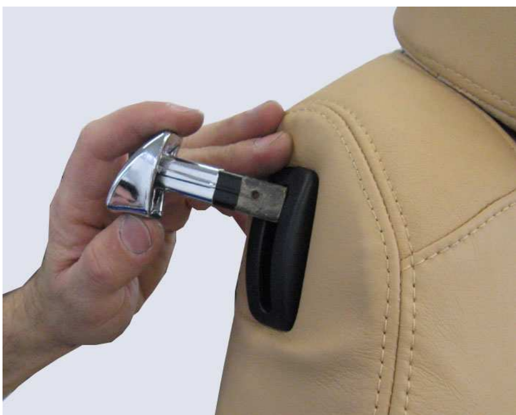
8. 拆卸座椅靠背倾斜装置的框架，它是通过压力安装在左右两侧。
