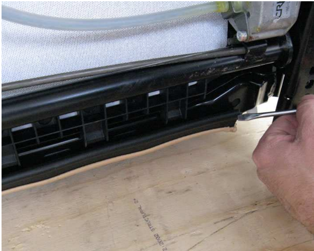
6. 撬出将座垫衬垫固定在座椅架上的水平紧固装置。
