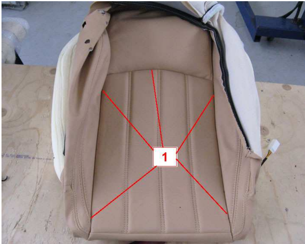
13. 使用一对钳子剪断衬垫内侧区域(1)周围的金属环。
